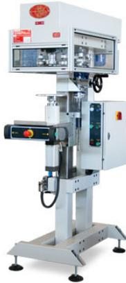
Aggraffatrice semiautomatica universale per la chiusura di barattoli in banda stagnata, cartone e plastica con capacità da 125 g. a 5 kg. La praticità d'uso e la semplicità nel cambio di formato la collocano al primo posto come macchina estremamente flessibile.
