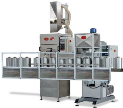
Impianto automatico per il confezionamento industriale di caffè in grani, caffè macinato, sementi, frutta secca, ingredienti per la ristorazione, in barattoli metallici, con capacità fino a 10 Kg. in atmosfera normale, sottovuoto, oppure in atmosfera protettiva con iniezione di azoto. Affidabile e robusta è l'ideale per chi vuole investire e avere la certezza della durata nel tempo del proprio investimento.
