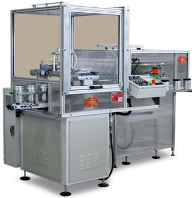
Macchina automatica per avvitare i tappi filettati di plastica sui barattoli. La macchina è composta da un magazzino vibrante, un trasportatore per i tappi, un trasportatore per i barattoli, un manipolatore e un nastro di uscita dei barattoli assemblati.
